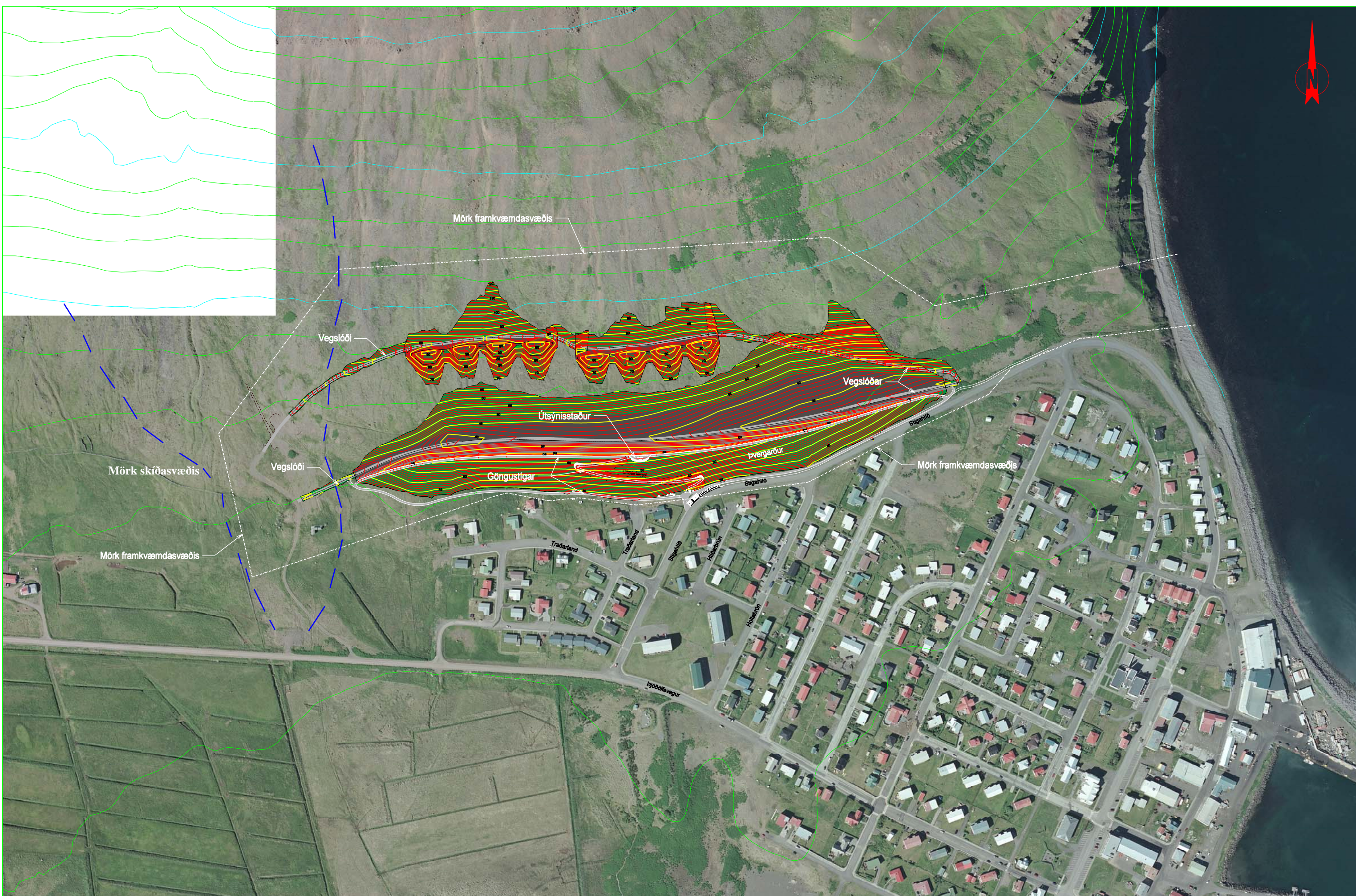
Mynd 1. Yfirlitsmynd yfir framkvæmdarsvæðið - Snjóflóðavarnir í Bolungarvík.
